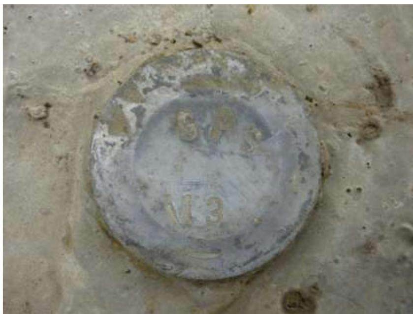
Punto materializado ubicado en el levantamiento topográfico
